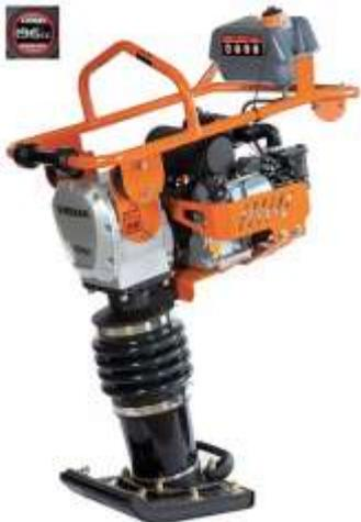
Вибротрамбовка FTR80H для утрамбовки поверхности из разных материалов в узких и тесных пространствах.
