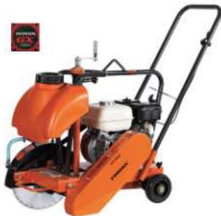
Резчик швов FCC300H предназначен для резки бетона, асфальта т д. Производится на базе двигателя Honda GX160, объемом 163 кубических сантиметра и мощностью 4,0 кВт (5,5 л.с.)
