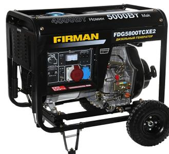
Дизельный генератор Firman FDG5800TCXE2 это дизельный трехфазный генератор марки Firman FDG серии, способен давать до 5 кВА электроэнергии напряжением 380В. через выходные розетки с заземлением. Firman FDG5800TCXE2 снабжён одноцилиндровым 4-х тактным, дизельным двигателем, мощностью 5.7 кВт, снабженный системой прямого впрыска и воздушного охлаждения. Для запуска используется как ручной, так и электрический стартер. Имеется система защиты низкого уровня масла.
